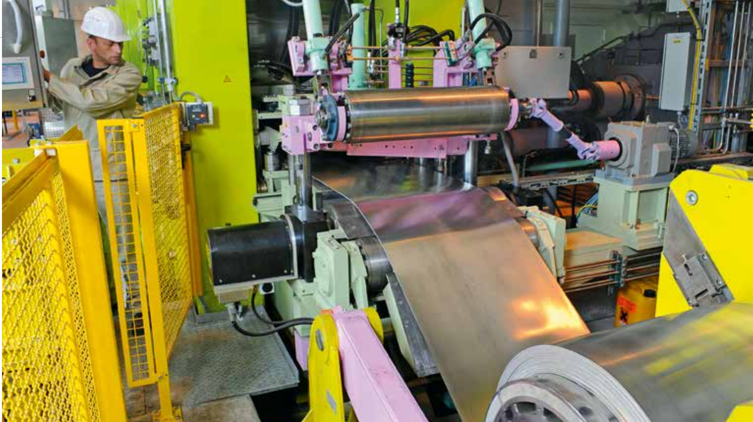
5,5 Millimeter dünne Magnesiumbänder laufen über die Pilotanlage der TU Bergakademie Freiberg. Sie wurden im Gießwalzverfahren hergestellt – einer Entwicklung des Wachstumskerns TeMaK.
