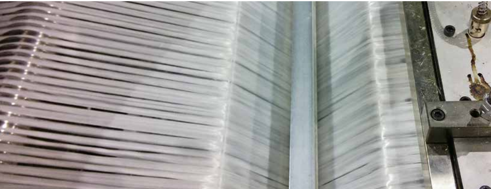
Am laufenden Band: Der Wachstumskern thermoPre® will thermoplastische Halbzeuge herstellen. Diese halbfertigen Materialien aus warm verformbaren Kunststoffen enthalten Verstärkungsfasern in praktisch unbegrenzter Länge.
