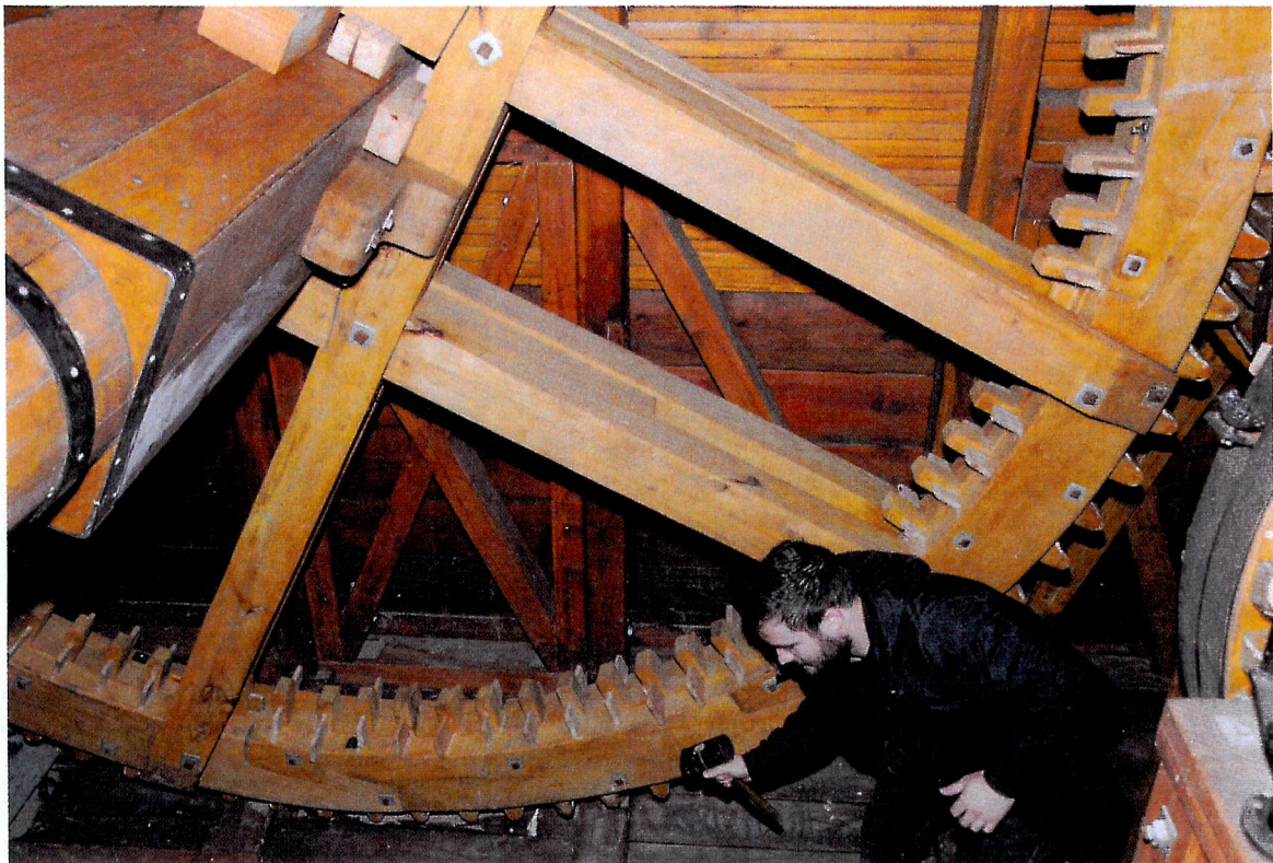
Abb. 3: Das Kammrad der historischen Schiffmühle in Magdeburg hat einen Durchmesser von stolzen vier Metern.
