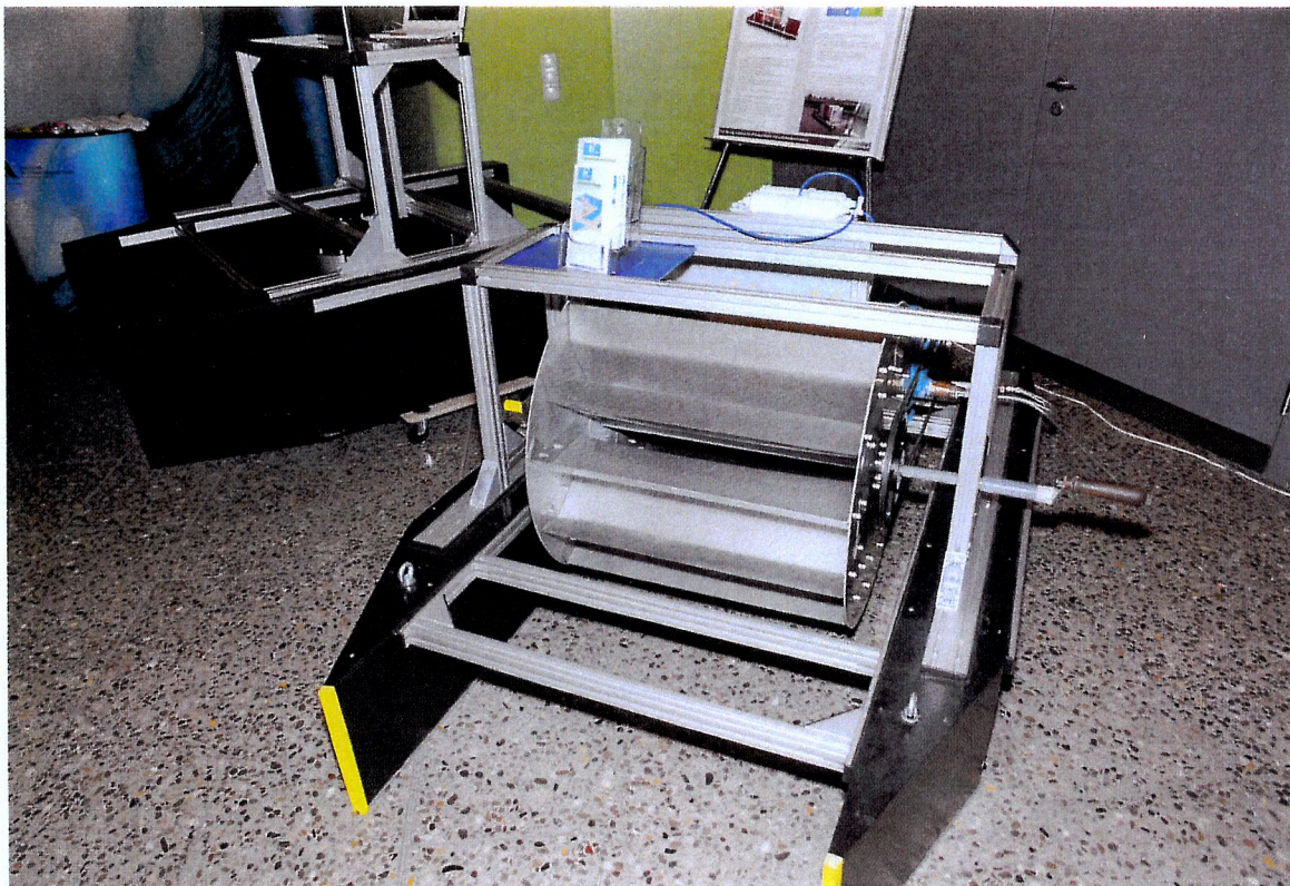
Abb. 7: In Magdeburg wurde eine Anlage entwickelt, die in der Lage ist, ohne elektrische Energie eine Wasseraufbereitung zu betreiben.
